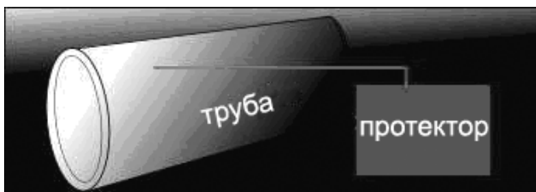
Рис. 4.9. Схема протекторной защиты
