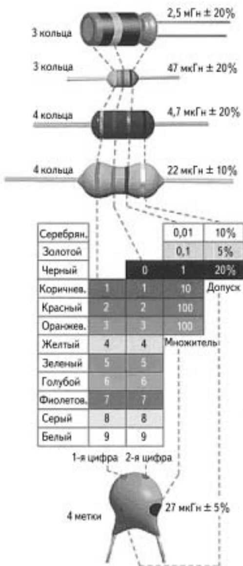
Рис. 42. Цветовая маркировка индуктивностей
