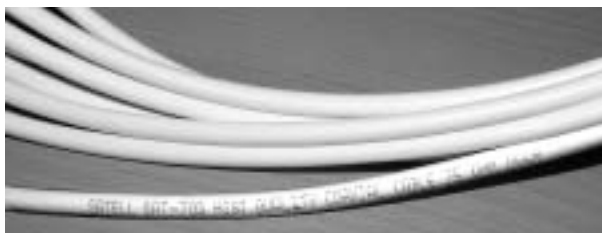
Рис. 5. Фото куска кабеля CAT703 китайского производства
