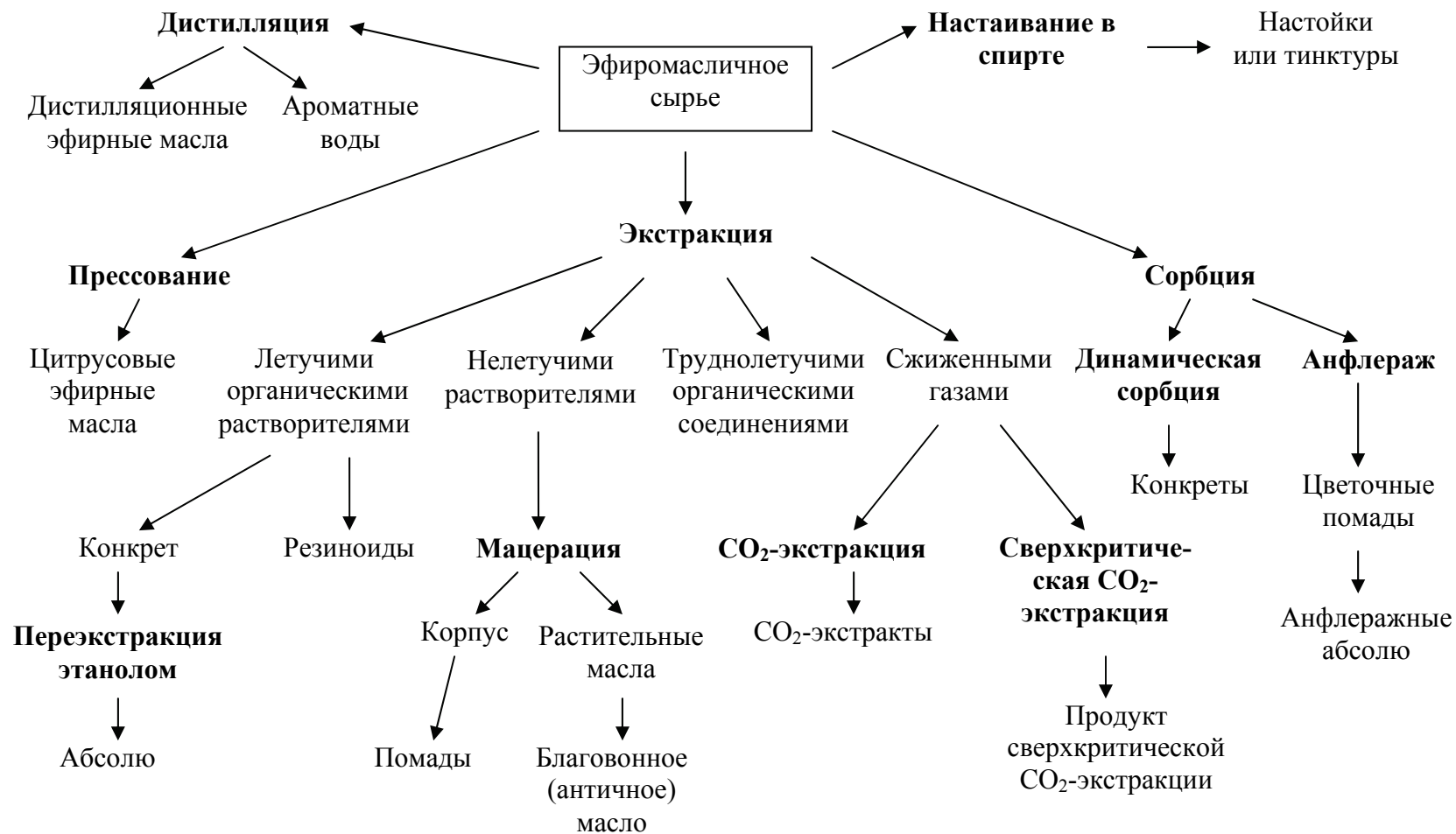
Рис. 4. Способы переработки эфиромасличного сырья и получения натуральных душистых продуктов
