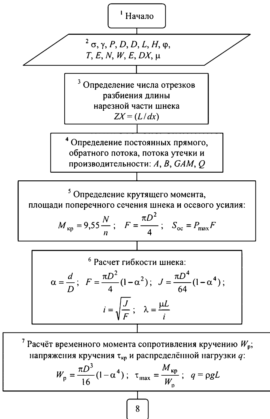
Рис. 3.28 Блок-схема алгоритма расчета консольного шнека на прочность и жесткость
