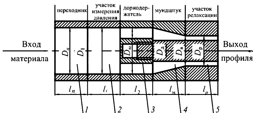
Рис. 3.33. Компоновка формующих каналов экструзионной головки: 1, 2 – цилиндрический; 3 – три канала произвольной формы; 4 – конический кольцевой; 5 – цилиндрический кольцевой
