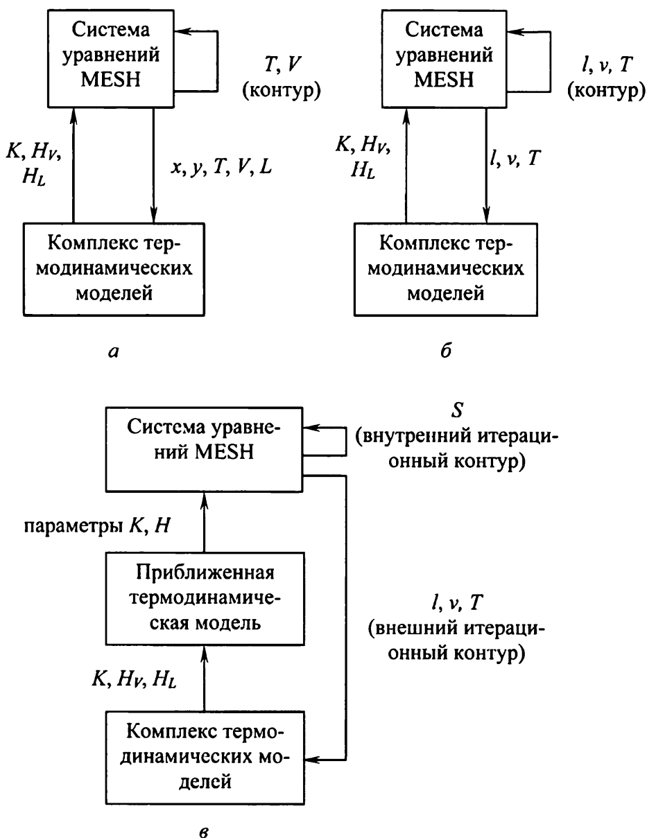
Рис. 3.11. Блок-схемы объединения термодинамических моделей в итерационные контуры: а – методов "Bubble-Point" и 2N-Ньютона, б – метода Ньютона-Рафсона, в – двухконтурного метода
