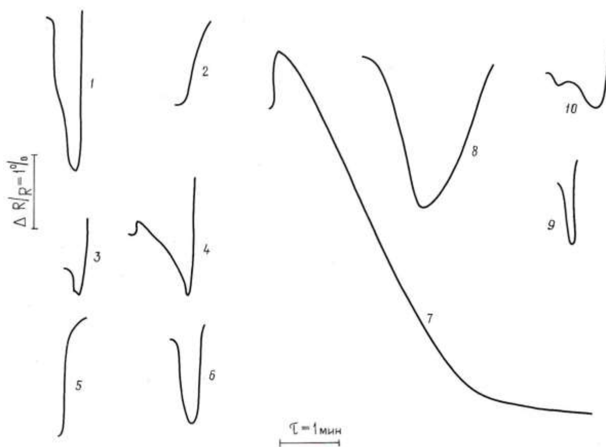
Рис.3.10. Потенциостатические R, \tau – кривые при E_r = -0,4 В для пленок хрома, полученных методом термического испарения (1-6) и катодного распыления (7-10).
