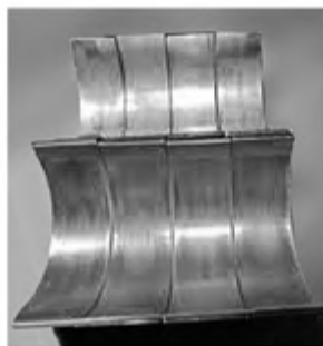
Медно-оловянный сплав для вкладышей в подшипниках скольжения
