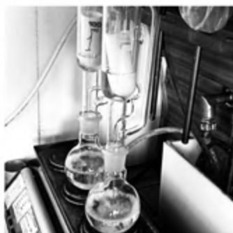
Прибор для экстракции — извлечения вещества из смеси
