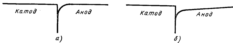
Фиг. 45. Распределение коррозии вблизи контакта двух металлов: а — вода с низкой электропроводностью; б — вода с высокой электропроводностью (схематически).
