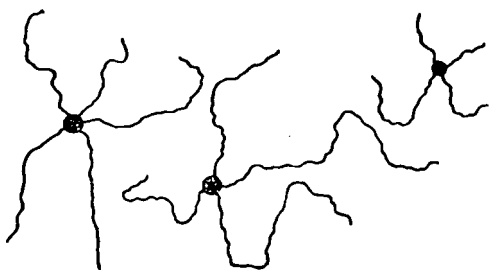
Фиг. 92. Нитевидная коррозия (схематически).
