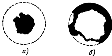
Фиг. 32. Распределение коррозии на стали в капле раствора хлористого калия:
