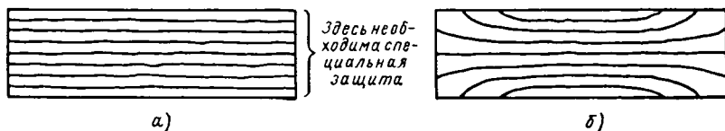
Фиг. 95. Зональная структура сварочного железа:
