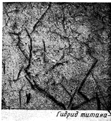
Фиг. 40. Микрофотография шлифа титанового образца после 2-часового отжига при температуре 300^\circ\text{C} . Перед отжигом на образце был гидридный слой толщиной 8 мк. \times 660 . Гидрид при охлаждении образца выделяется в виде тонких иголок.
