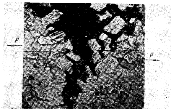
Фиг. 34. Микрошлиф с участка титанового образца, расположенного при испытании над ватерлинией. 2%-ный раствор брома в метиловом спирте. Напряжение 35 \text{ кг/мм}^2 . Образец разорвался непосредственно над ватерлинией через 6 ч. \times 200 . p — p — направление растягивающих напряжений.
