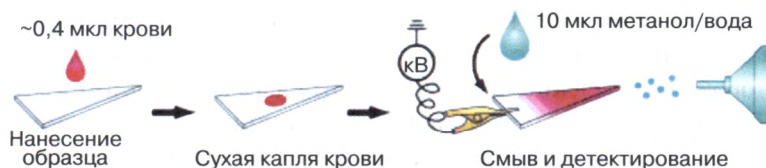
Рис. 9.8. Схематическое изображение спрея с бумаги
