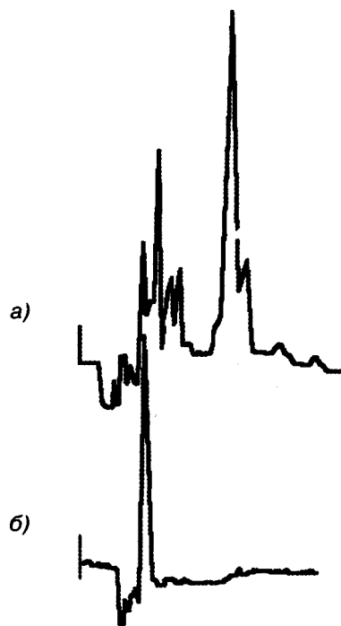
Рис. 12.15. Масс-фрагментограмма низкого R = 500 , m/z 74 (а) и высокого R = 5000 , m/z 74,0480 разрешения (б) образца, содержащего диметилнитрозамин
