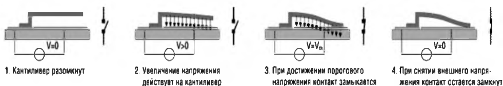
Рис. 55. Принцип действия электромеханической памяти
