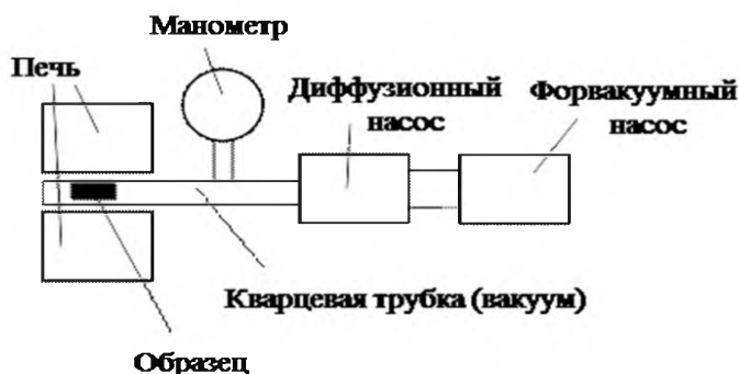
Рис. 7. Схема установки для термического разложения материалов
