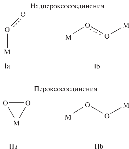
Рис. 14.4. Четыре основных типа координационной геометрии \text{O}_2\text{—M} . Мостиковые типы Ib и IIb выглядят совершенно одинаковыми, однако они заметно различаются двугранными углами и другими параметрами связи. См. также примечание к табл. 14.5 о недавно открытом уникальном надпероксиде с \mu, \eta^1 -мостиком
