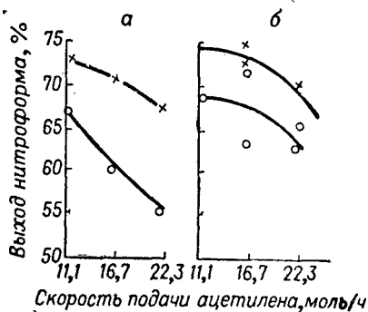
Рис. 85. Зависимость выхода нитроформа от скорости подачи ацетилена и количества нитроформа, циркулирующего в системе, при высоте нитрационной колонны 2,55 м (а) и 3,55 м (б):
