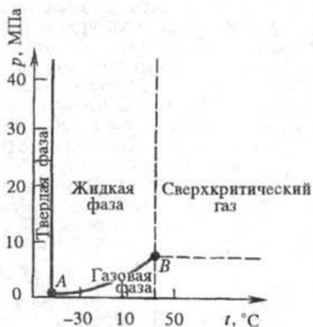
Рис. 60. Диаграмма состояния диоксида углерода: А – тройная точка; В – критическая точка
