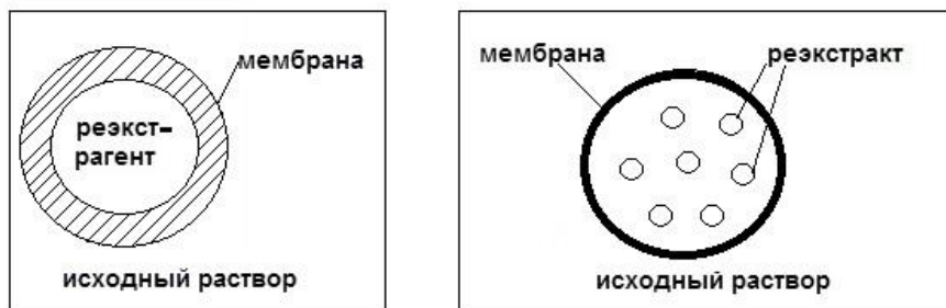
Рис. 22. Принципиальная схема мембранной экстракции во множественной эмульсии
