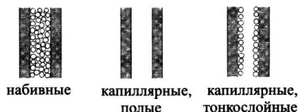
Рис. 108. Типы колонок для газоадсорбционной хроматографии
