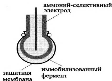
Рис. 121. Биокаталитический мембранный сенсор на основе аммоний-селективного электрода и фермента уреазы
