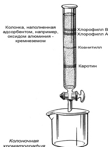
Рис. 99. Разделение растительных пигментов на хроматографической колонке
