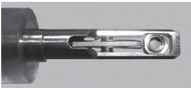
Рис. 3.5. Фотография держателя образца (в правой части видна медная сетка с перфорированной углеродной пленкой)
