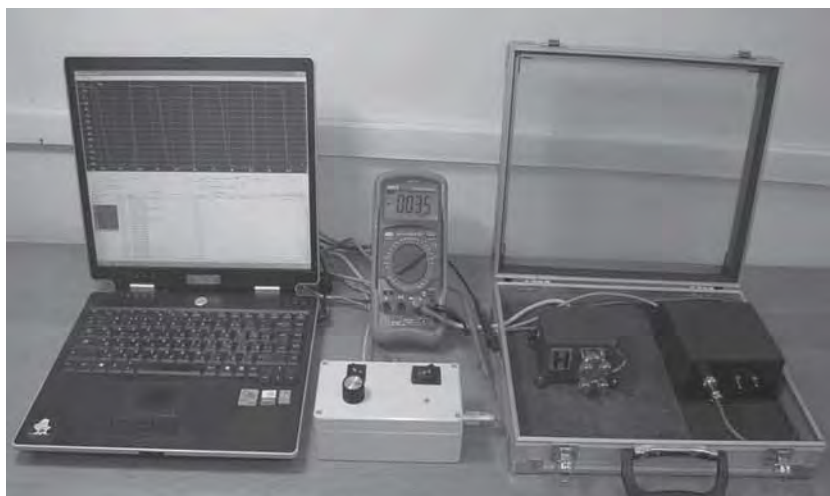
Рис. 5.10. Фотография лабораторной установки в составе ноутбука, цифрового вольтметра, блока питания с регулируемым выходным напряжением, линейного оптического интерферометра с субнанометровым разрешением
