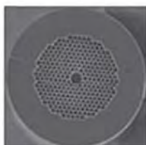
Рис. 4.8. Различные типы фотонно-кристаллических волокон с воздушным ядром (производство фирмы «ThorLabs»)
