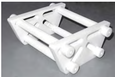
Рис. 6.12. Оснастка для образца
