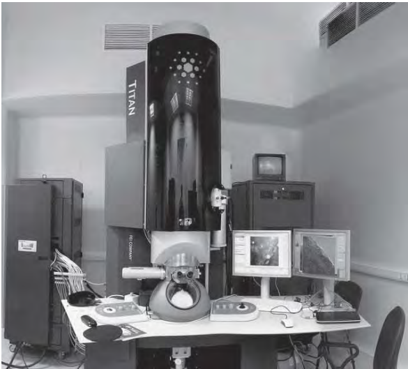
Рис. 3.2. Просвечивающий электронный микроскоп Titan™ 80-300 с атомарным разрешением
