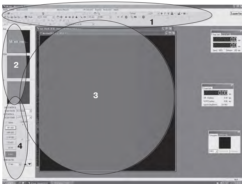
Рис. 4.24. Окно программы LMeye.exe с указанием рабочих областей: 1 — главное меню, 2 — окна контроля изображения, 3 — текущее изображение, 4 — меню управления параметрами сканирования
