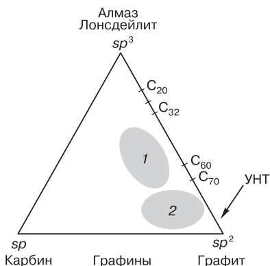
Рис. 6.1. Упрощенная треугольная диаграмма с различными формами углерода по типу связей: 1 — область аморфного углерода, 2 — область стеклоуглерода [107]
