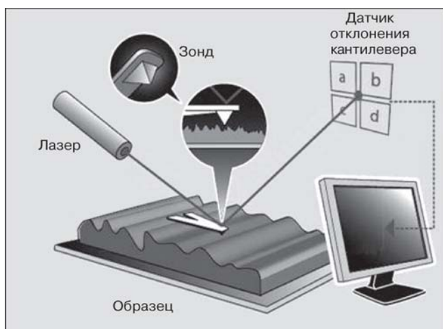
Рис. 5.70. К пояснению работы атомно-силового микроскопа
