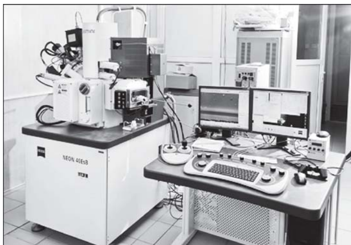
Рис. 5.29. Двухлучевой растровый электронный микроскоп Neon 40
