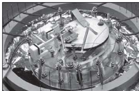
Рис. 5.60. Внешний вид первого сканирующего туннельного микроскопа (реконструкция) [299]
