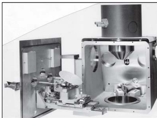
Рис. 5.26. Камера образцов РЭМ. Источник: http://lab.bmstu.ru/rem/parts2/parts2/index.htm
