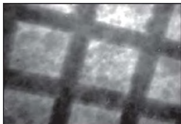
Рис. 5.15. Частицы Al в органической пленке толщиной 270 мкм [280]
