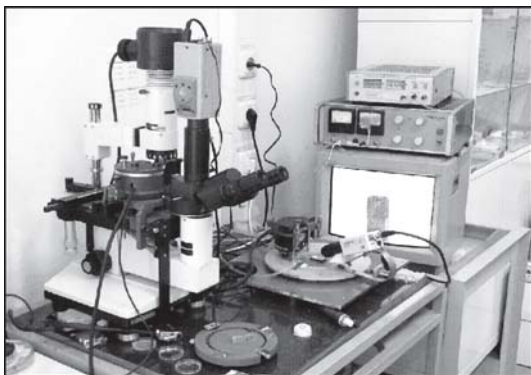
Рис. 5.82. Ближнепольный сканирующий оптический микроскоп Aurora™. Источник: http://spm.unn.ru/equipment/equipmentru.htm
