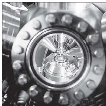
Рис. 5.68. Высоковакуумная камера сканирующего туннельного микроскопа. Источник: http://www.popmech.ru/article/711-tunnel-v-nanomir
