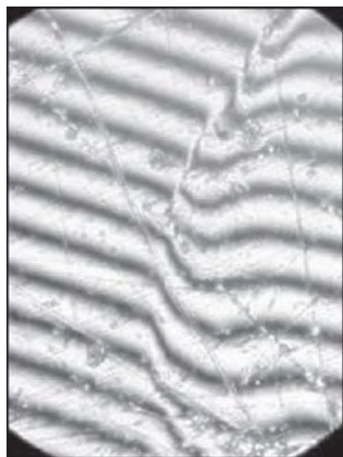
Рис. 4.7. Искривление линий в микроинтерферометре Линника
