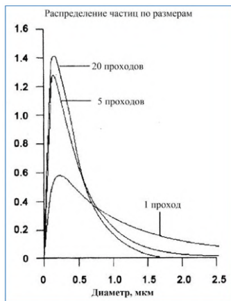
Рис. 21. Обычное распределение размера капель в зависимости от числа проходов эмульсии через высокооборотный проточный смеситель типа ротор–статор
