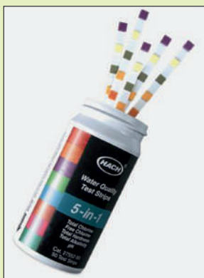
Рис. 8.4. Индикаторные полоски для одновременного определения 5 компонентов: общего хлора, свободного хлора, общей жесткости, щелочности, pH
