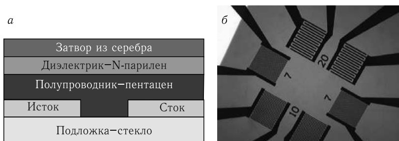
Рис. 8.5. Структура тонкопленочного органического полевого транзистора (а) и микрофотография рабочей области готового органического полевого транзистора (б). Серый фон — полупрозрачный затворный слой из серебра [185]
