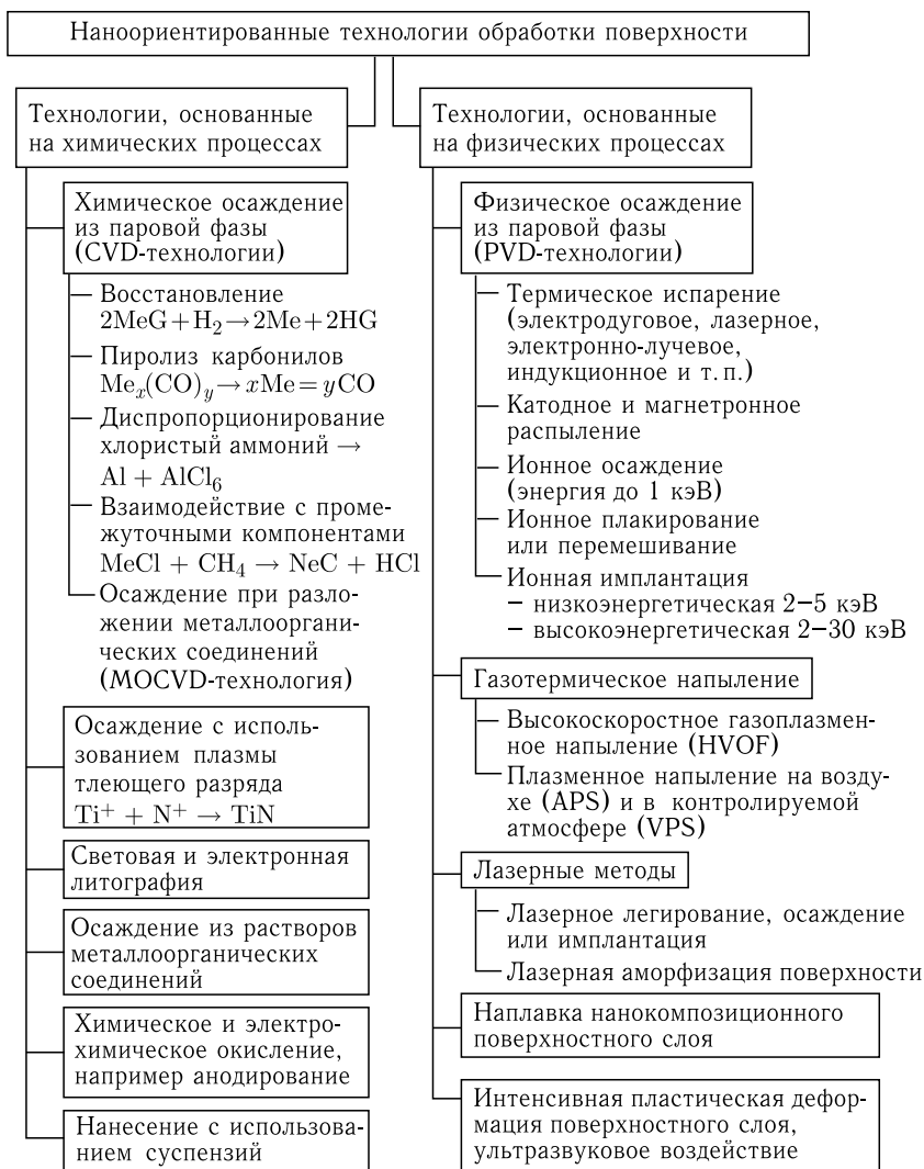
Рис. 8.1. Примерная классификационная схема наноориентированных технологий обработки поверхности
