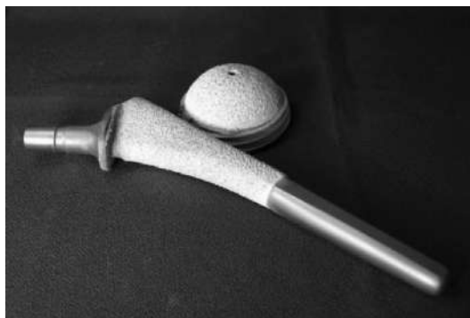
Рис. 8.34. Пример титанового имплантата для тазобедренного сустава со сложной трехмерной системой наноструктурных покрытий [135, 248]
