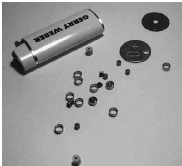
Рис. 9.8. Покрытие на основе углеродного полимера для подшипников гироскопов [299]
