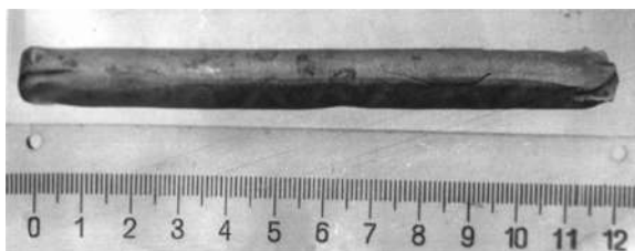
Рис. 4.14. Заготовка из нанопорошка никеля, полученная методом ГИП [35]
