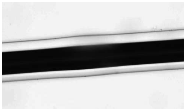
Рис. 6.4. Одномерный композит на базе наноаморфного сплава \text{Fe}_{77,5}\text{Si}_{7,5}\text{B}_{15} и оболочки из стекла типа «Пирэкс». Толщина стеклянной оболочки 4 мкм [140, 141]
