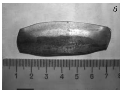
Рис. 4.13. Пример образцов, полученных спеканием под давлением нанопорошков из никеля (а) и железа (б) [35]
