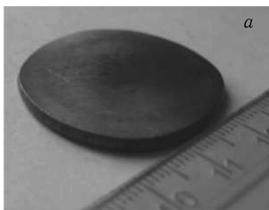
Рис. 4.13. Пример образцов, полученных спеканием под давлением нанопорошков из никеля (а) и железа (б) [35]
