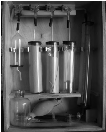
Рисунок 37 – Комплект оборудования для газовых анализов КГА 1-1: 1 – гребенка; 2 – бюретка; 3 – фильтр; 4, 5, 6 – сосуды поглотительные; 7 – колба с тубусом; 8 – баллон перекачивающий; 9 – воронка; 10 – трехходовой кран.
