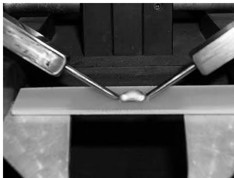
Рисунок 102 – Возникновение электрической дуги между электродами
