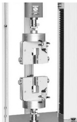
Рисунок 80 – Захваты для закрепления и удержания образцов при испытании на растяжение при комнатной температуре
