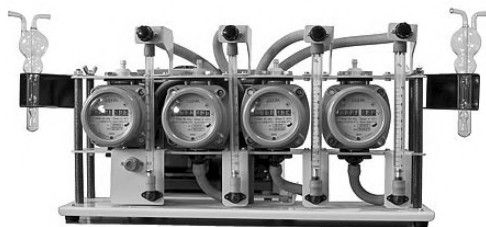
Рисунок 32 – Устройство отбора проб воздуха (пробоотборник) УОПВ-4
