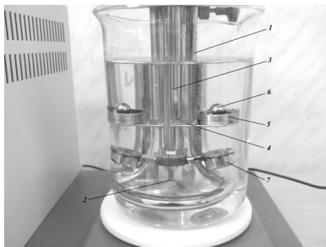
Рисунок 107 – Прибор для определения температуры размягчения по методу «кольцо – шар»
