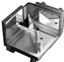
Рисунок 129 – Интерферометр Майкельсона
