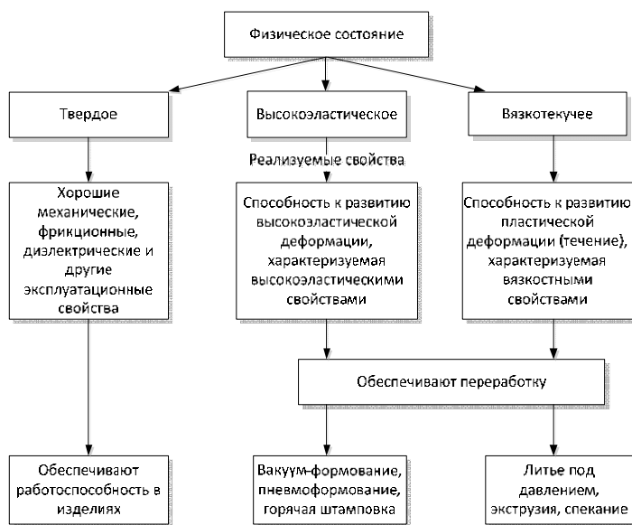
Рисунок 45 – Физические состояния полимера при эксплуатации и переработке разными методами
