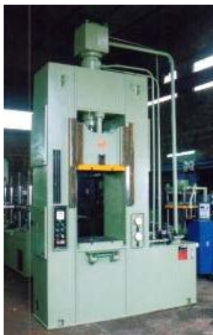
Рис. 3.9. Рамный гидравлический пресс: 1 – стойки; 2 – плиты; 3 – главный гидроцилиндр; 4 – дифференциальный плунжер; 5 – шток; 6, 7 – уплотнительные манжеты; 8 – подвижная верхняя плита; 9 – направляющие; 10 – верхняя и нижняя рабочие плиты; 11 – гидроцилиндр выталкивателя; 12 – дифференциальный плунжер выталкивателя; 13 – уплотнительные манжеты; 14 – шток выталкивателя; 15 – конечные выключатели (ограничители хода) верхней плиты; 16 – конечные выключатели хода выталкивателя; 17 – электроконтактный манометр давления; 18 – пульт управления пресса; 19 – стол
