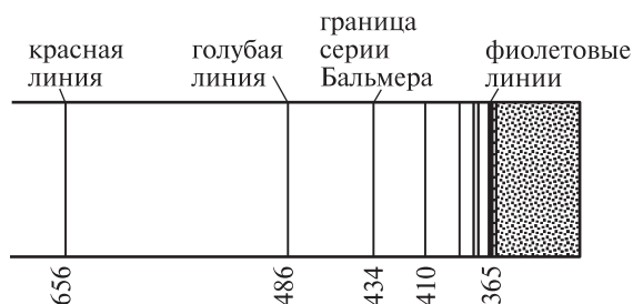
Рис. 8.3. Линейчатый спектр атомарного водорода. Серия линий Бальмера
