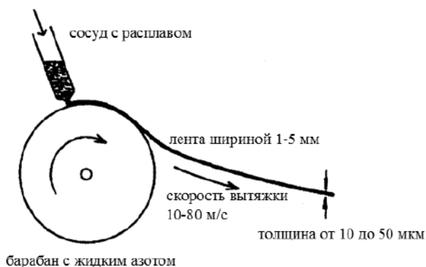
Рис. 20.1. Вытяжка металлической ленты из расплава (по обзору [283])
