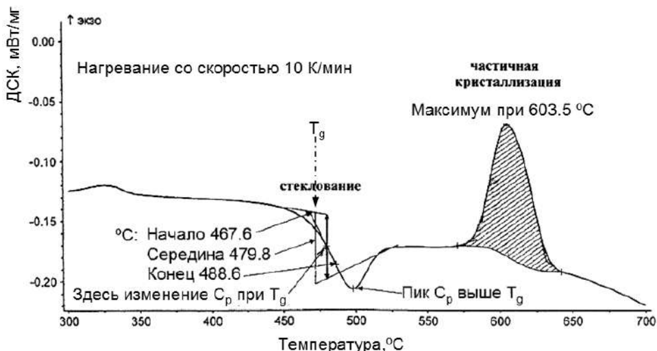
Рис. 5.5. Типичная экспериментальная кривая ДСК (поглощенная образцом теплота в процессе нагревания). Фотохромное стекло. Показаны начало, середина и конец области стеклования, положение релаксационного пика; тепловыделение при кристаллизации. Изменение C_p находится после дифференцирования кривой теплосодержания до начала области стеклования и после её окончания. Тепловой эффект кристаллизации определён размером заштрихованной площади. График представлен А. И. Игнатьевым.
