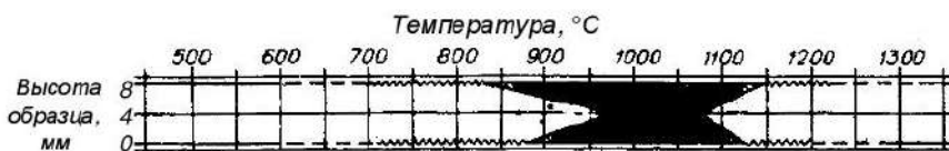
Рис. 5.6. Диаграмма кристаллизационной способности опытного стекла, выдержка в градиентной печи 24 ч, по [94]
