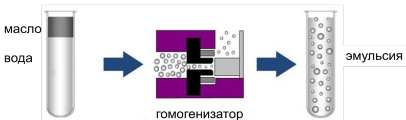
Рис. 3.3. Схема гомогенизации продуктов
