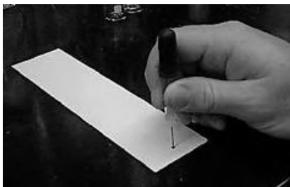
Рис. 38 – Нанесение пробы образца на линию старта хроматограммы (А); микрошприцы (В)
