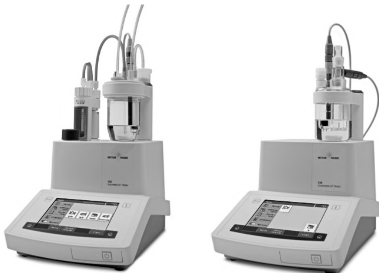
Рис. 2. Автоматические приборы для титрования реактивом К. Фишера: А – классическим волюмометрическим методом; Б – методом кулонометрии.
