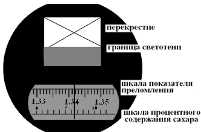
Рис. 23. Изображение в поле зрения окуляра рефрактометра PZO (тип RL)
