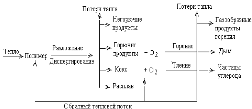
Рисунок 4.8. Схема горения полимерных материалов
