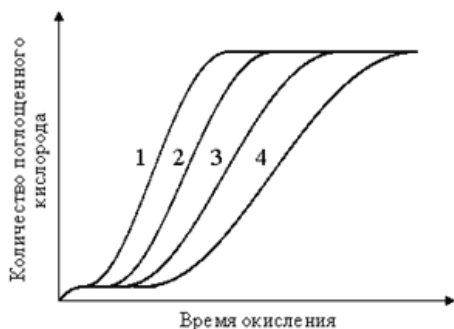
Рисунок 4.2. Кинетические кривые окисления полипропилена при различных температурах: 1 – 150 °C, 2 – 140 °C, 3 – 130 °C, 4 – 120 °C
