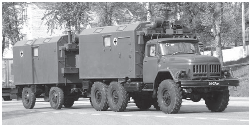
Рис. 5.8. Передвижная военно-химическая лаборатория
