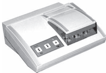
Рис. 6.2. Прибор для инверсионной вольтамперометрии. На таком приборе можно осуществить вещественный анализ
