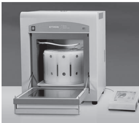
Рис. 15.2. Лабораторная МВ-печь. Пробоподготовка с использованием микроволнового излучения получает все более широкое распространение
