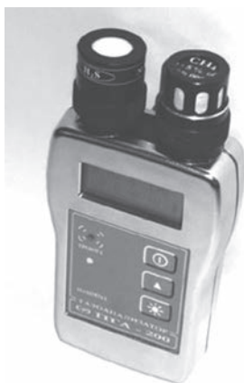
Рис. 7.7. Персональный газоанализатор с 14 сменными сенсорами на отдельные газы фирмы Dräger
