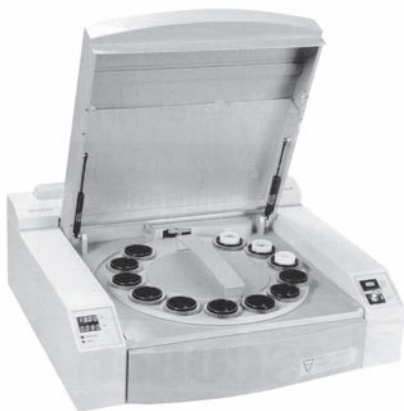
Рис. 5.5. Серу в нефти можно определять рентгенофлуоресцентным методом
