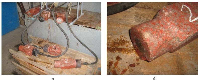
Рис. 82. Установка для испытаний защитных свойств разработанных составов при поступлении водо-рассолопритоков под давлением (а); образец после разгерметизации (б)
