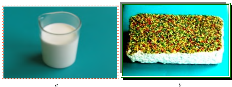
Рис. 105. Пример применения модифицированной ВД ЭС (а) для нанесения структурно-декоративного покрытия на поверхность пенопласта (б)
