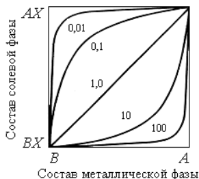
Рис. 4.6. Изотермы равновесия для реакции (4.6)
