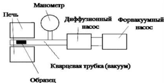
Рис. 7. Схема установки для термического разложения материалов
