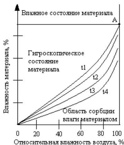
Рис. 1. Кривые равновесной влажности в зависимости от изменения температуры окружающей среды, где t_1 < t_2 < t_3 < t_4
