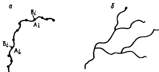
Рис. 3.34. Элементарные схемы изображения макромолекул: a — линейная макромолекула ( A — группы основной цепи; B — боковые группы); b — статистически разветвленная макромолекула
