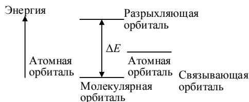
Рис. 3.23. Молекулярные орбитали в двухатомной молекуле
