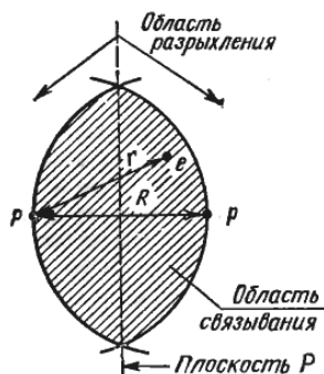
Рис. 2.26. Области связывания и разрыхления для частицы \text{H}_2^+
