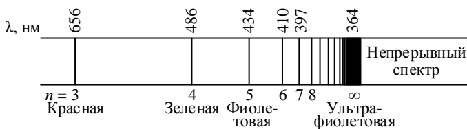
Рис. 1.2. Спектр излучения атома водорода (серия Бальмера)
