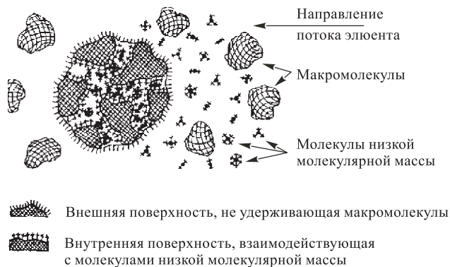
Рис. 9.1. Разрез частицы пористого кремнезема с двухсортными гетероповерхностями
