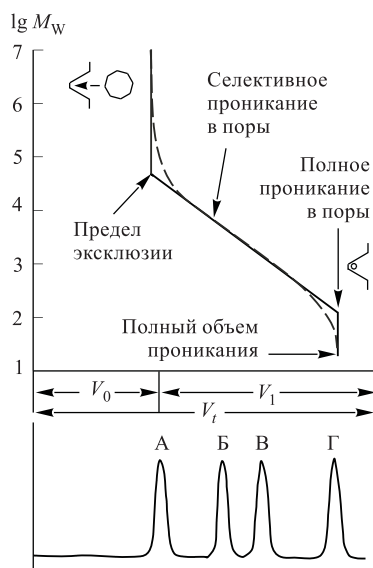
Рис. 7.9. Градуировочный график хроматографической колонки для эксклюзионной хроматографии и соответствующее разделение
