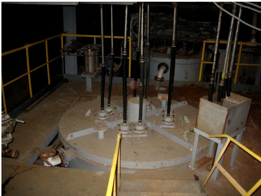
Рис.4.31. Холодильник серной кислоты с фторопластовыми охлаждающими элементами (вид сверху)
