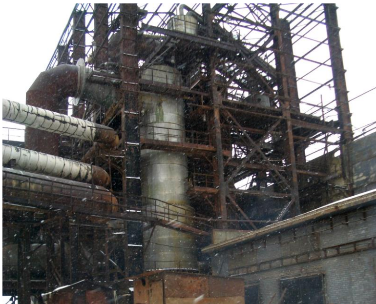
Рис. 1.20. Фотография промышленного вихревого моногидратного абсорбера серной кислоты
