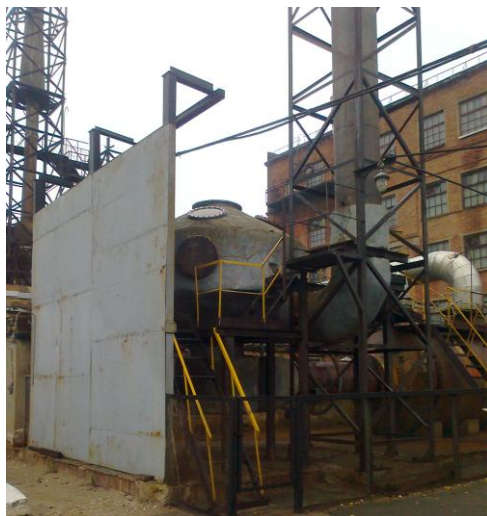
Рис. 2.43. Реактор каталитического восстановления оксидов азота (г. Пермь)
