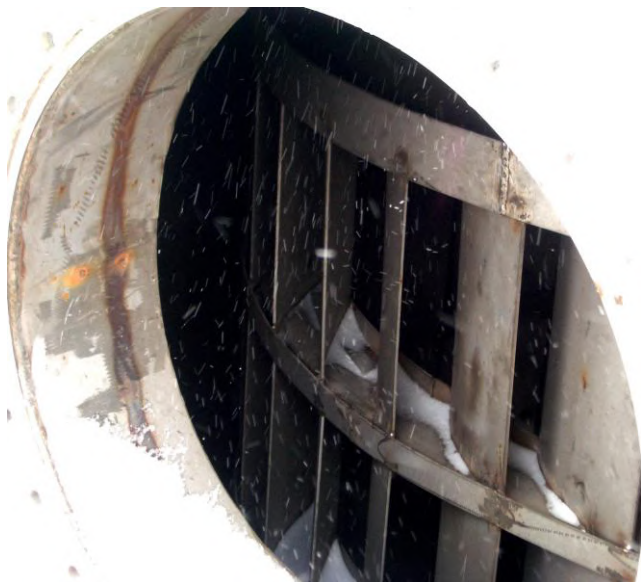
Рис. 1.23. Лопатки завихрителя промышленного вихревого моногидратного абсорбера серной кислоты
