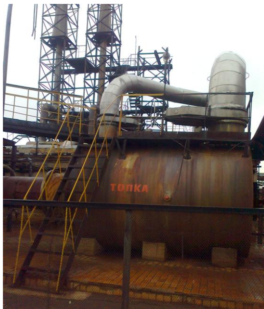
Рис.2.42. Топка нагрева газов установки каталитического восстановления оксидов азота
