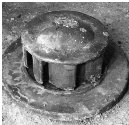
Рис.3.58 Тарелка с завихрителем
