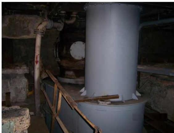
Рис.4.17. Фотография днища вихревой ферросилидовой колонны со стороны входа газа
