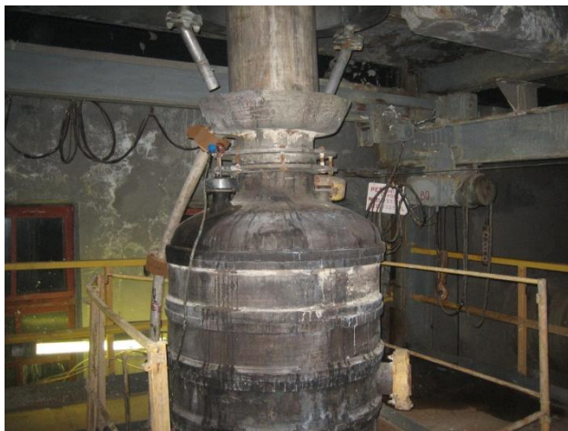
Рис.4.15. Фотография вихревой ферросилидовой колонны в области верхней части колонны
