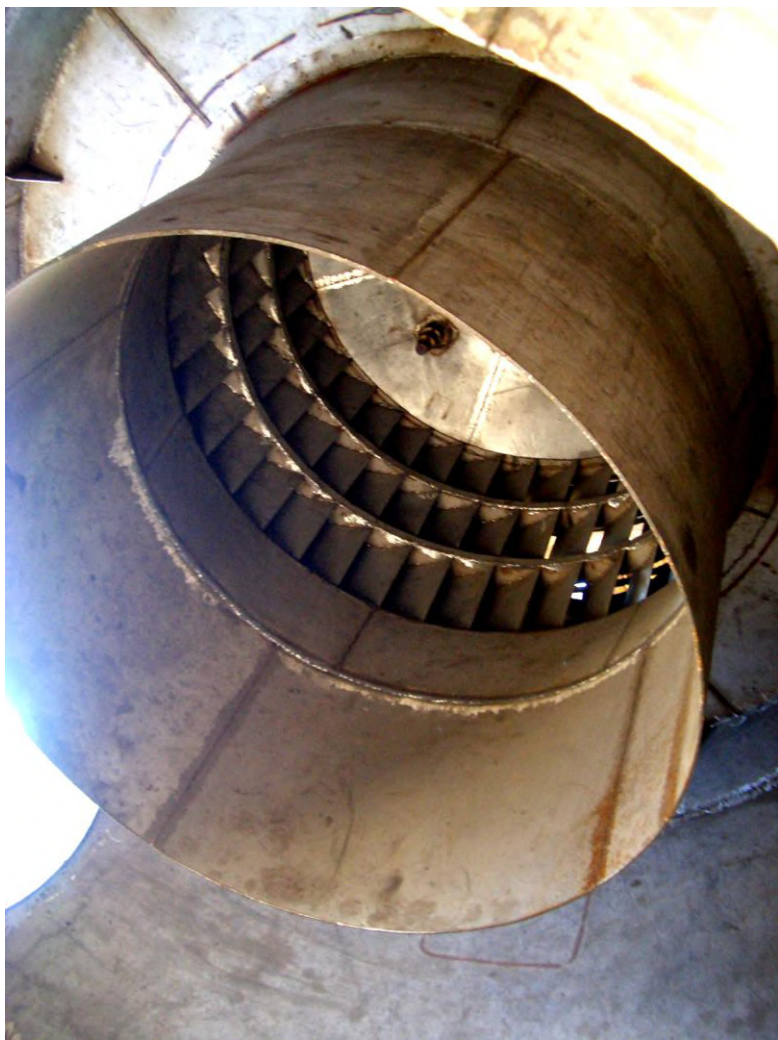
Рис. 1.22. Вид на завихритель промышленного вихревого моногидратного абсорбера серной кислоты
