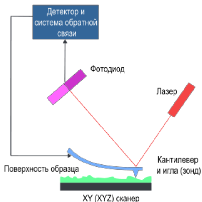
Рис. 3.4. Схема работы атомно-силового микроскопа
