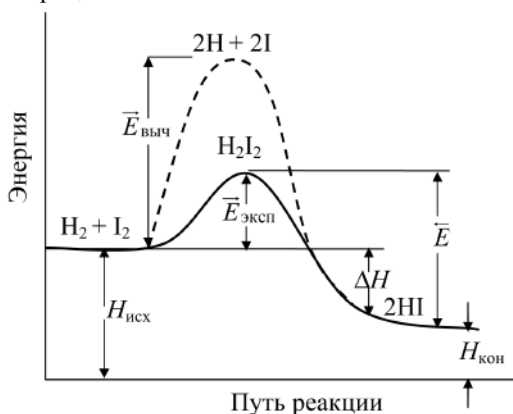
Рис. 4.3. Энергетическая диаграмма реакции водорода и йода (энергия активации обозначена буквой E без индекса)
