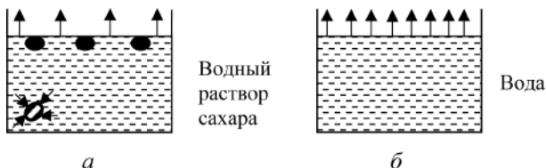
Рис. 5.5. Давление пара раствора нелетучего вещества (а) меньше давления пара растворителя (б)
