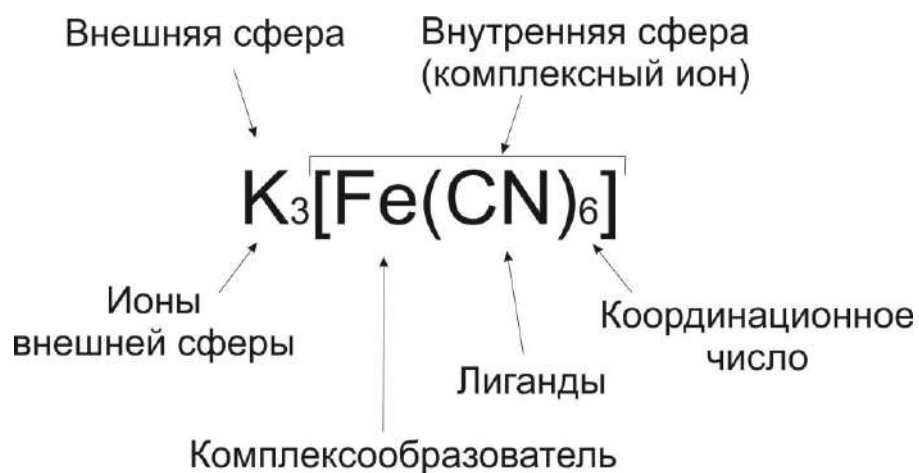
Рис. 28. Строение комплексного соединения
