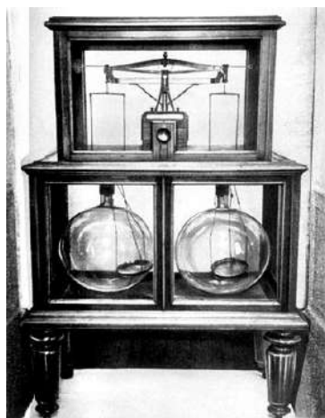
Рис. 43. Весы, сконструированные Д. И. Менделеевым
