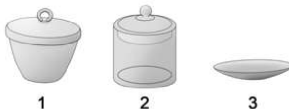
Рис. 48. Посуда для взвешивания твердых веществ: 1 – тигель; 2 – бюкс; 3 – часовое стекло
