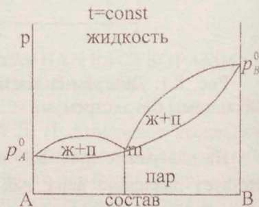
Рис. 8.3. Диаграмма состав-давление пара двойной жидкой системы с минимумом
