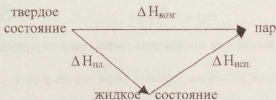
Рис. 3.2. Схема, поясняющая процесс возгонки
