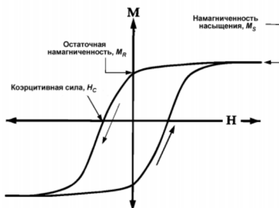
Рис.39. Петля гистерезиса и основные параметры магнитных материалов.
