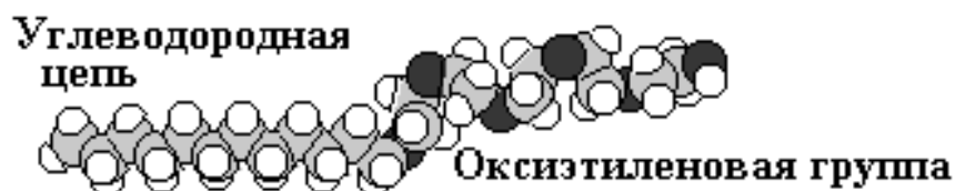
Рис. 7.2. Компьютерная модель молекулы неионогенного ПАВ
