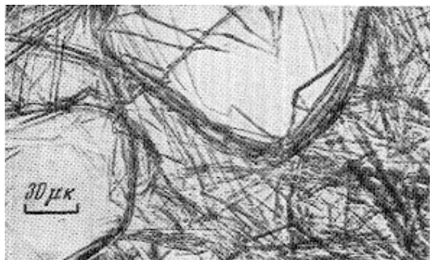
Рис. 3.7. Микрофотография кристаллов неионогенного ПАВ ДС-8
