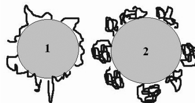
Рис. 8.10. Схема адсорбционного слоя полимерного эмульгатора на поверхности частиц полимера в латексе.
