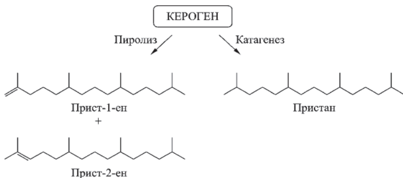
Рис. 17. Пиролитическое выделение в лаборатории алкенов (прист-1-ен и прист-2-ен) из керогена (S. Killops, V. Killops, 1993)
