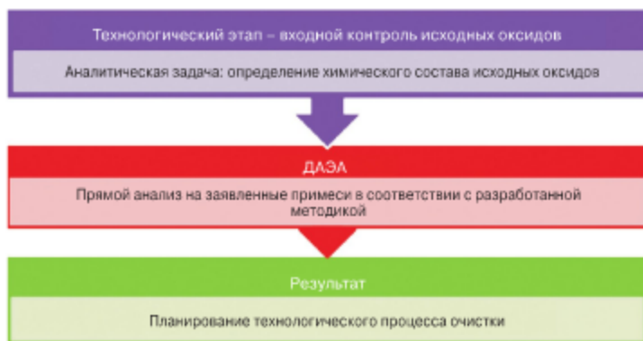
Рис. 6.3. Роль ДАЭА в технологическом процессе на стадии входного контроля исходного сырья
