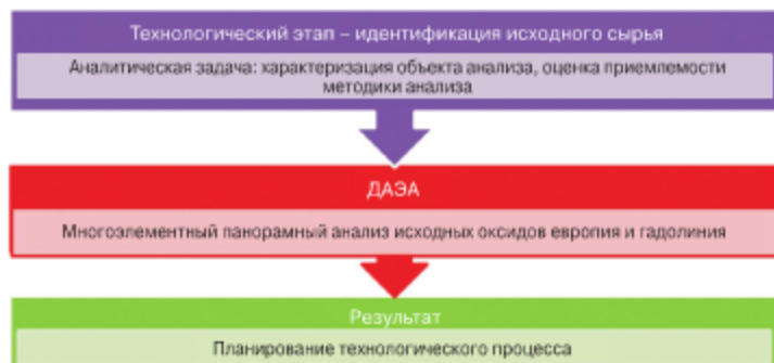
Рис. 6.2. Роль ДАЗА в технологическом процессе на стадии идентификации исходного сырья
