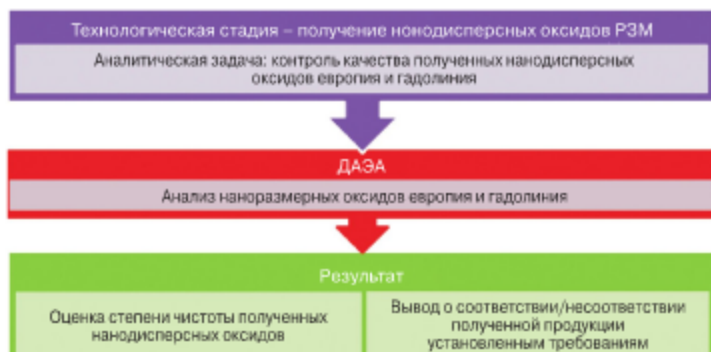
Рис. 6.6. Роль ДАЗА в контроле качества готовой продукции
