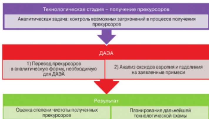
Рис. 6.5. Роль ДАЗА в технологическом процессе на стадии получения прекурсоров нанодispersных оксидов европия и гадолиния
