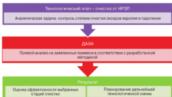
Рис. 6.4. Роль ДАЭА в технологическом процессе на стадии очистки исходных оксидов европия и гадолиния
