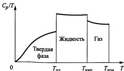
Рис. 6.5. Типичная зависимость C_p/T от T для индивидуального химического соединения, претерпевающего два фазовых перехода в диапазоне температур от 0 до T_{\text{кон}}
