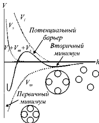
Рис. 2.4 Зависимость энергии парного взаимодействия частиц ( V ) от расстояния ( h ) между ними
