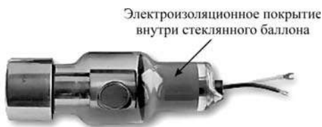
Рис. 6.21 Изображение рентгеновской трубки со стекляннным баллоном и изоляционным покрытием, нанесенным золь-гель методом
