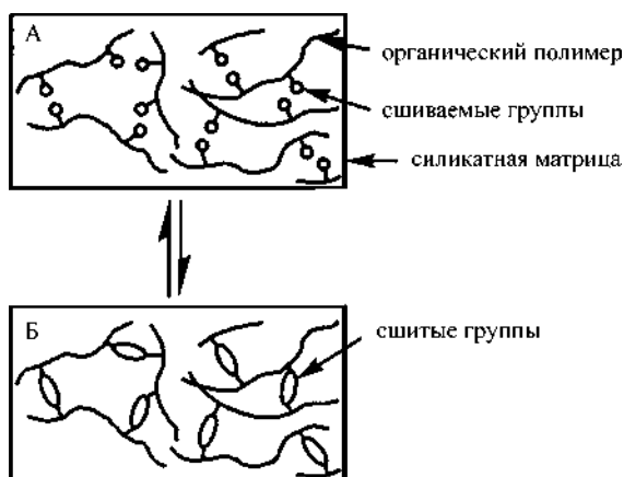
Рис. 3.11 Схематическое изображение органо-неорганического гибрида с различным типом взаимопроникающих сеток:
