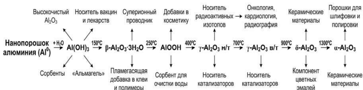
Рис. 2.19.2. Схема термических превращений продуктов взаимодействия нанопорошка алюминия с водой и области их применения
