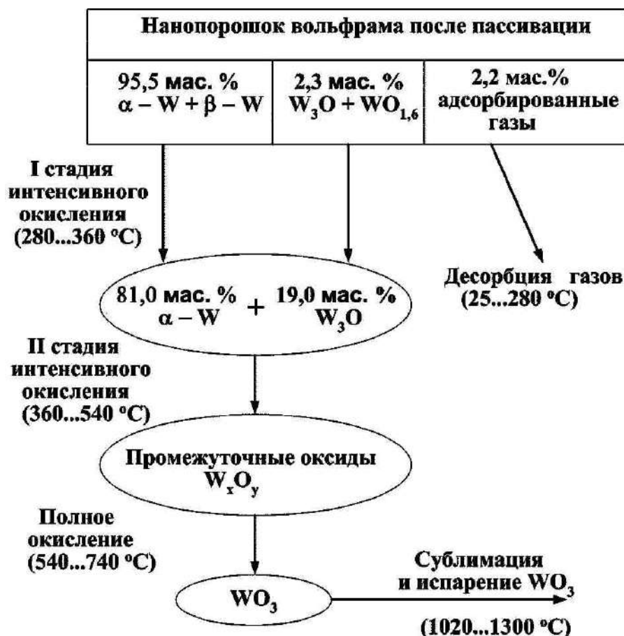
Рис. 2.7.5. Схема процессов в нанопорошке вольфрама при нагревании в воздухе
