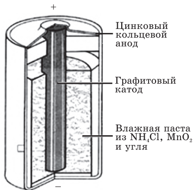
Рис. 11.2 «Сухой» гальванический элемент
