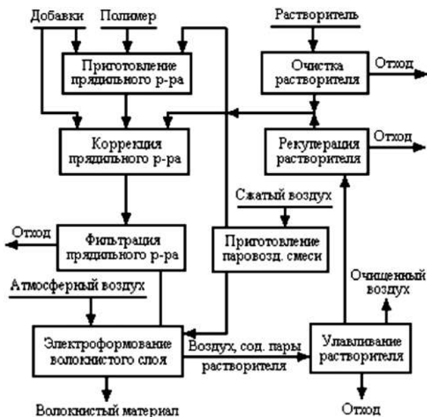
Рис. 30 Технологическая схема ЭФВ-процесса
