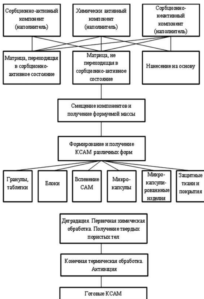
Рис. 38 Принципиальная схема получения композиционных сорбционно-активных материалов
