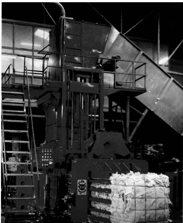
Рис. 21. Общий вид гидравлического пресса и формируемой им кипы отходов
