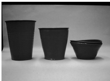
Рис. 13. Различная степень коробления изделий при разных температурных условиях их эксплуатации
