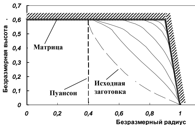
Рис. 22. Результаты моделирования процесса вакуумного формования полимерной упаковки из предварительно вытянутой пуансоном листовой заготовки: профили заготовки ( — ) в различных фазах процесса формообразования изделия; ( - - - ) — исходный профиль вытянутой пуансоном заготовки.
